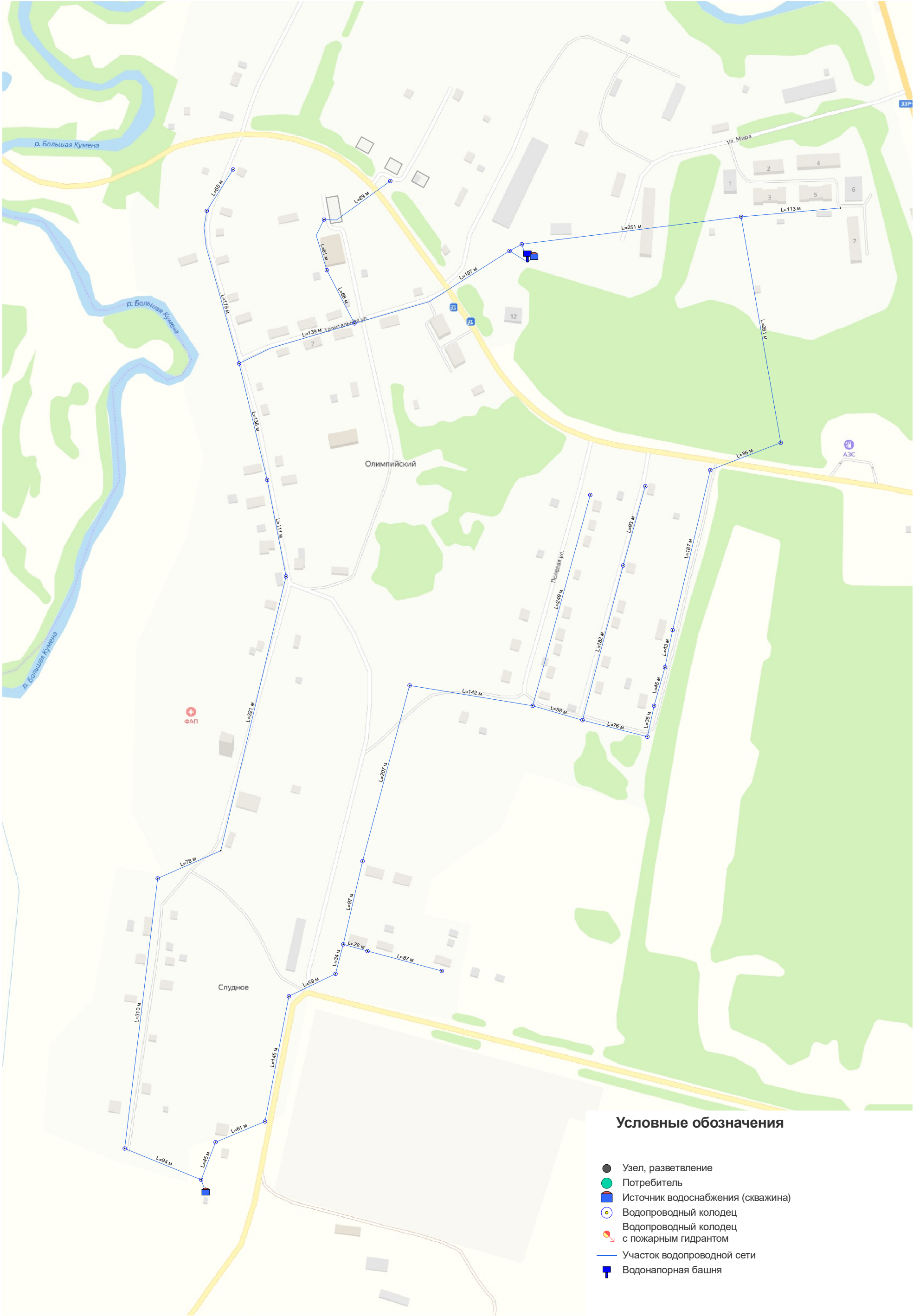
Приложение 2 - Схема сетей водоснабжения п. Олимпийский и д. Слудное
